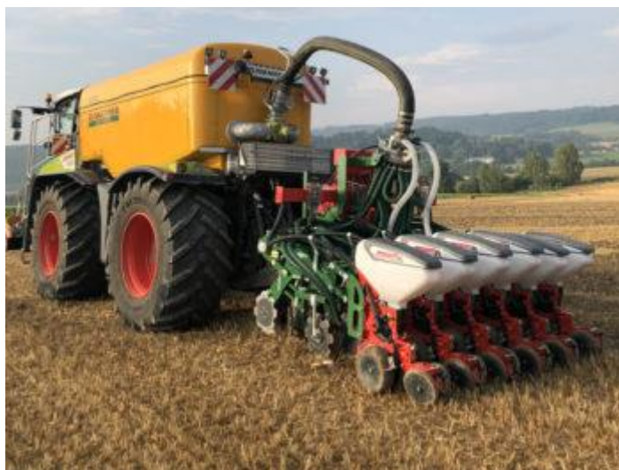
Obr. 7 Pásová aplikace kejdy a setí
