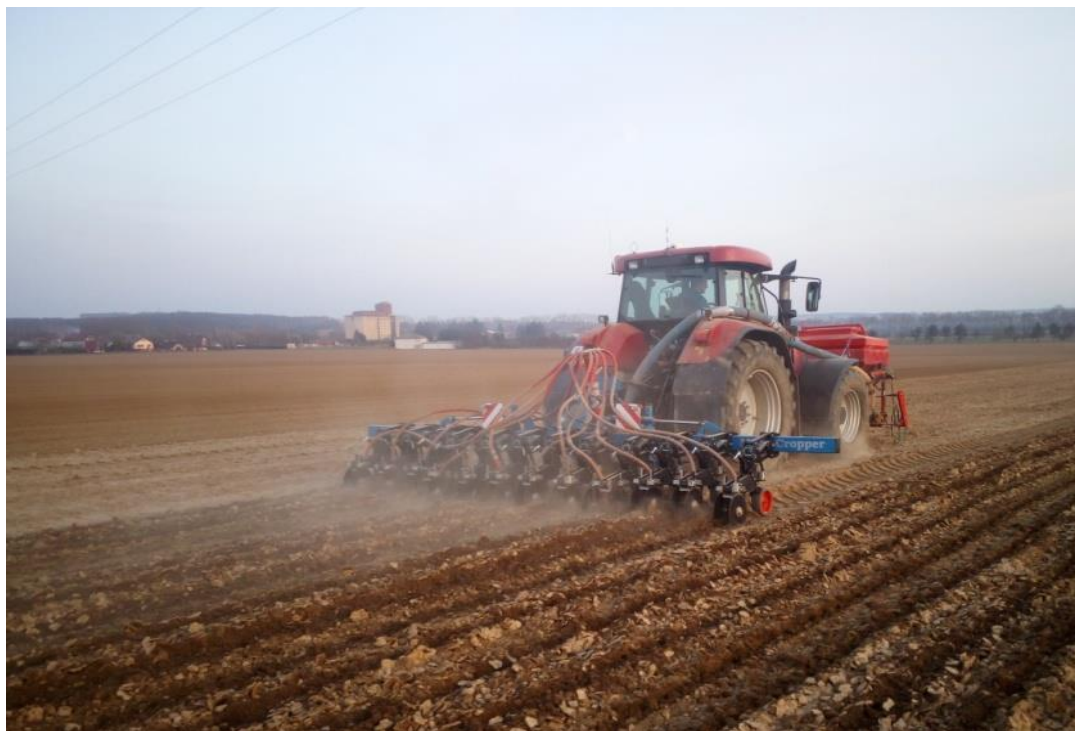
Obr. 16 Využití modifikovaného kypřiče P&L Multi cropper při aplikaci hnojiva do zpracovaných pásů
