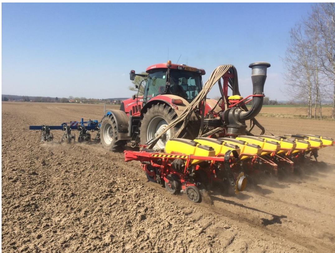
Obr. 22 Souprava traktoru s pásovým kypřičem a secím strojem
