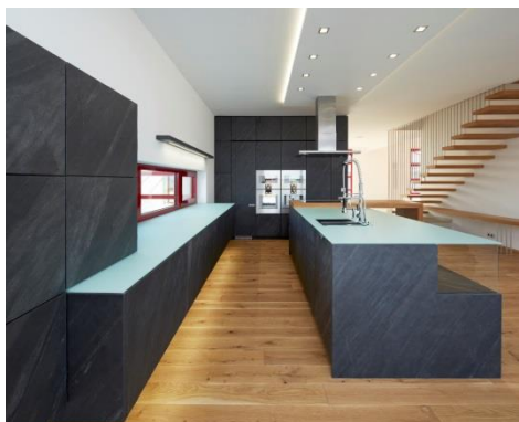
Obr. 51 Kuchyně z materiálu s kamennou dýhou (lugi web)
