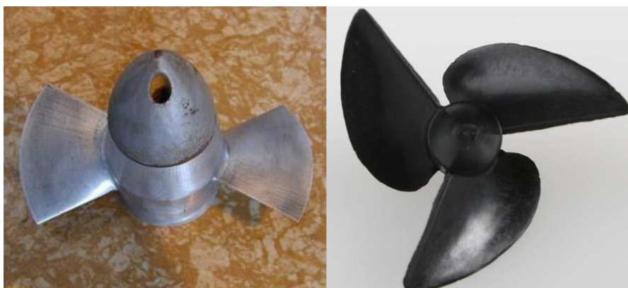
Obr. 27: Srovnání lodního šroubu (vpravo) a vírové turbíny (vlevo) [12,17]
