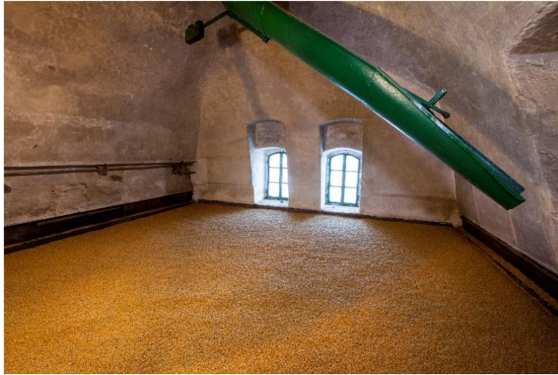
Obrázek 5: Líska v Novopackém pivovaru (foto: Petr Čepek)
