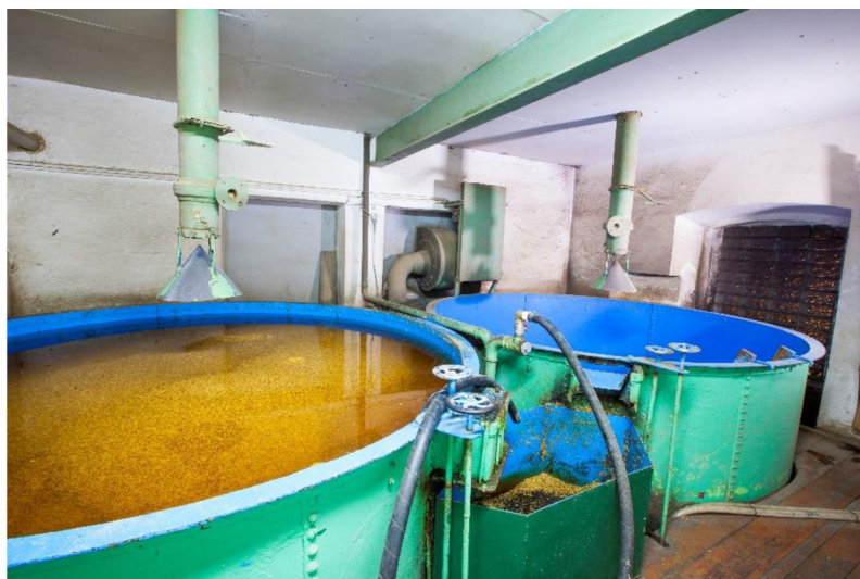
Obrázek 2: Náduvník v novopackém pivovaru (foto: Petr Čepek)
