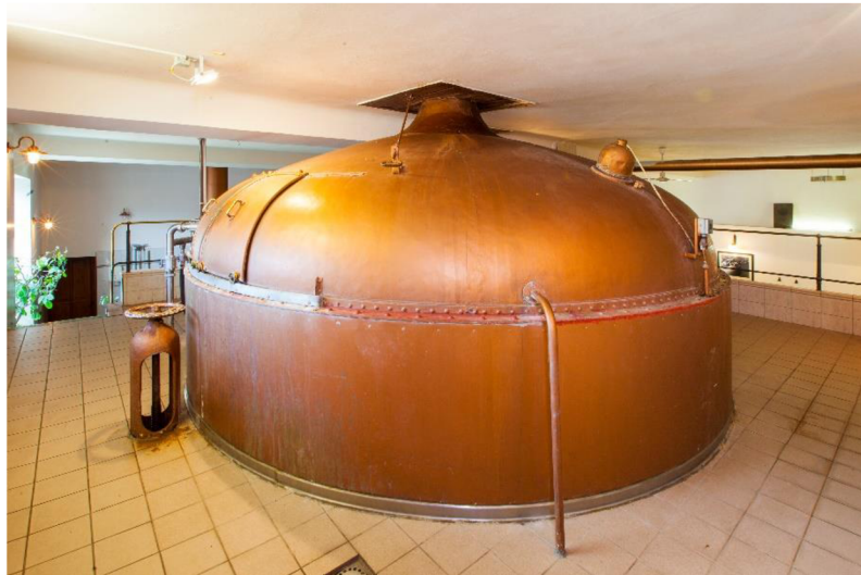
Obrázek 7: Vystírací a scezovací kád' v Novopackém pivovaru (foto: Petr Čepek)
