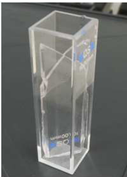
Obr. 36 Nachystaný gelový vzorek k měření na Fluorologu. Gel je v tenké vrstvě nanesen mezi dvě křemenná skla, které jsou diagonálně umístěny v klasické křemenné kyvetě.
