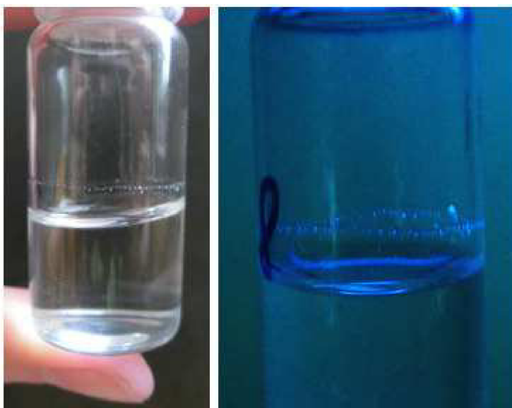
Obr. 29 Vzniklá kondenzovaná fáze na stěně vialky u vzorku s 0,1 \text{ mmol}\cdot\text{l}^{-1} CTAB. Vlevo – foceno za denního světla. Vpravo – foceno ve fotokomore s UV zářením.
