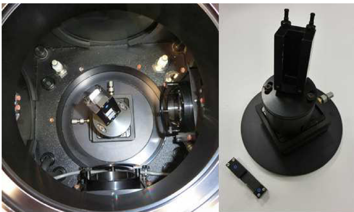
Obr. 37 Použitý nástavec pro měření gelových vzorků na přístroji Fluorocube.
