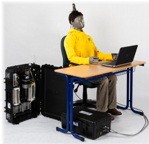
Obrázek 4.2: Tepelný manekýn Newton se všemi dostupnými komponenty
