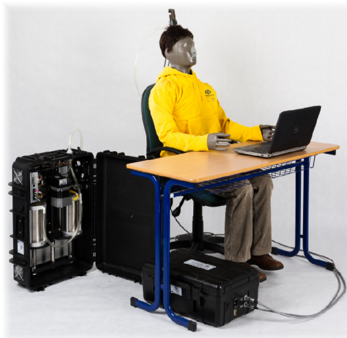
Obrázek 4.2: Tepelný manekýn Newton se všemi dostupnými komponenty
