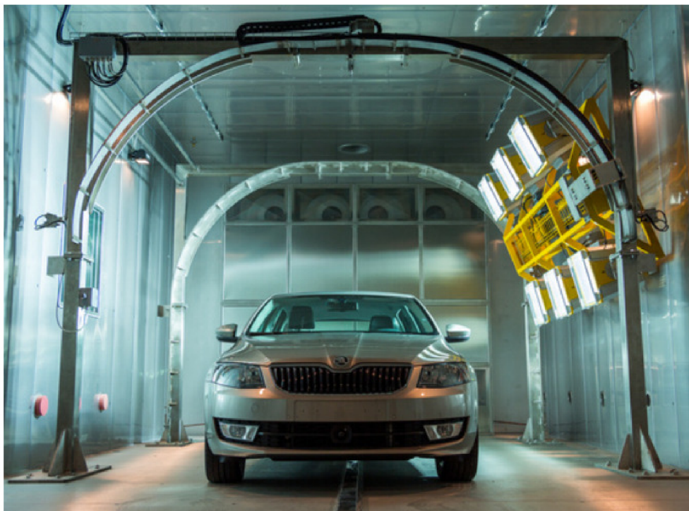
Obrázek 4.1: Klimatická komora na FSI
