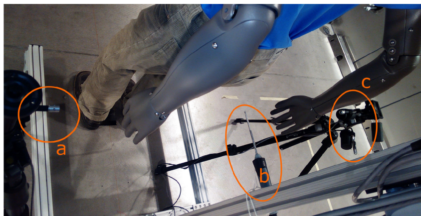
Obrázek 4.11: Detailní pohled na umístění čidel
