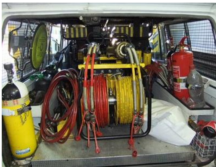
Příloha 2 - Vybavení vozidla RZA Nissan Patrol určené k vyproštění z havarovaných automobilů (HZS Kralupy nad Vltavou)
