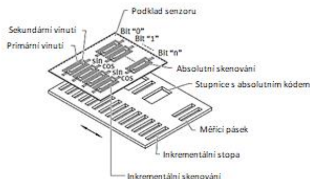
Obr. 41) Princip bezkontaktního induktivního snímání [36]
