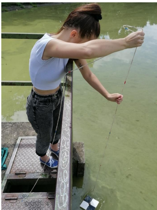
Obr. 4: Měření průhlednosti vody vodní nádrže Bagr za pomoci Secchio desky v místě vypustního zařízení ze dne 26. 8. 2022 (Foto: P. Blabolil).
