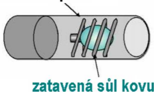
Obr.12 Bezelektrodová výbojka (Metody spektrální,2015)
