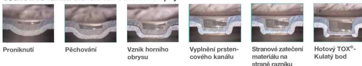
Jednotlivé fáze tváření klinčovaného spoje
