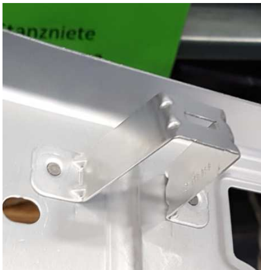
Obr. 13 - Ukázka samočinného nýtování, vlevo pohled od strany nýtovaný, vpravo pohled na snýtovaný součásti z druhé strany – vlastní foto
