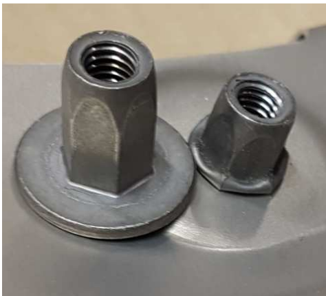
Obr. 9 – Porovnání nového a snýtovaného maticového nýtu. Vlevo nový maticový nýt, vpravo snýtovaný maticový nýt v plechové součásti – vlastní foto
