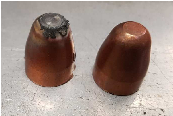
Obr. 26 - Proudové špičky, vlevo opotřebovaná po 225 svařených bodech, vpravo nová proudová špička – vlastní foto
