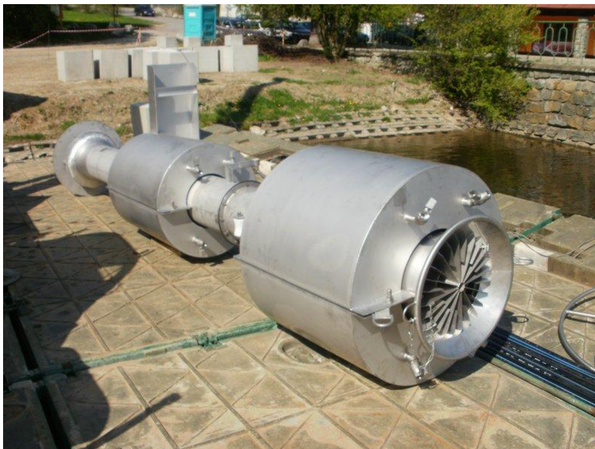
Obr. 1.12.1 Čerpadlové aerační věže použité při projektu čištění Brněnské přehrady [8]
