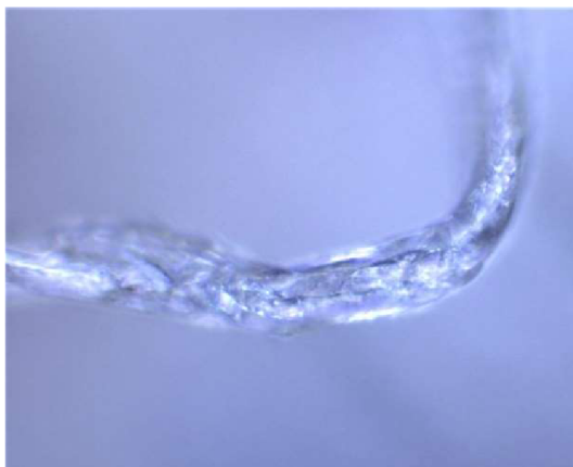
Identifikace MP – celulóza (K_25_zima)
