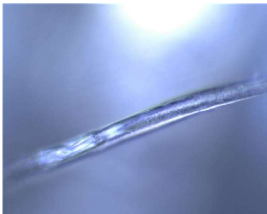
Identifikace MP – PET (K_25_zima)
