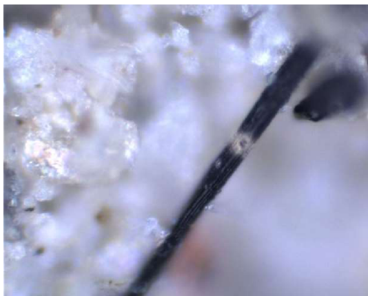
Identifikace MP – celulóza (K_25_zima)
