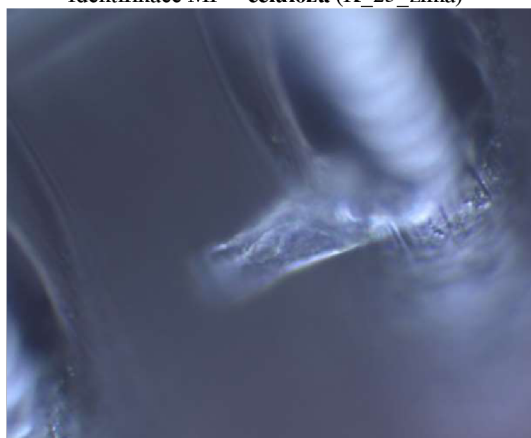
Identifikace MP – nylon (A_50_jaro)
