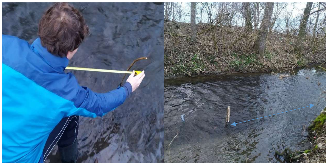
Obrázek 22: Ukázka plovákové metody (řeka Haná).
