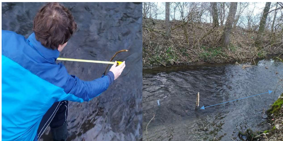
Obrázek 22: Ukázka plovákové metody (řeka Haná).
