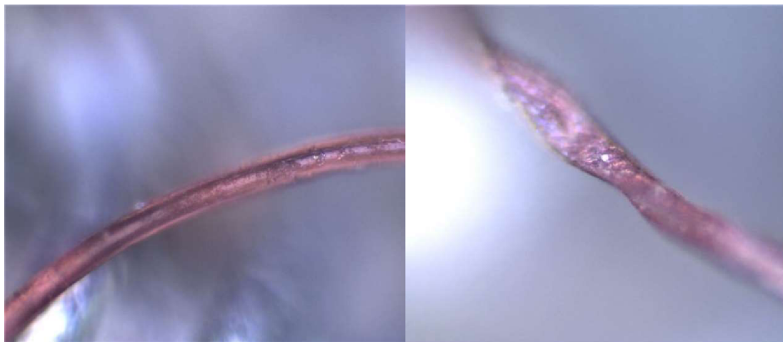
Obrázek 26: Zbarvené vlákna mikroplastů po obarvení bengálskou červení, potvrzeno identifikací Ramanovou spektroskopií.
