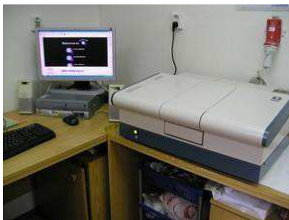
Obr. 9: UV-VIS spektrometr Cintra 202 [40]
