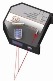
Obr. 15) Triangulační laserový princip [8]
