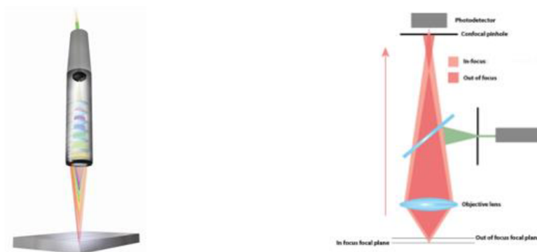
Obr. 25) Princip konfokálního senzoru [8]
