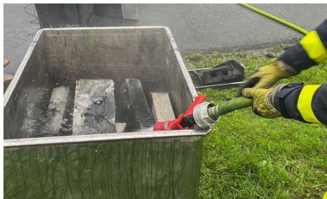
Obr. 19 – Baterie ponořené do vodní lázně [41]
