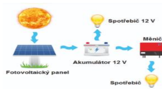
Obr. 8 - Schéma Off – grid ostrovního fotovoltického systému [10]
