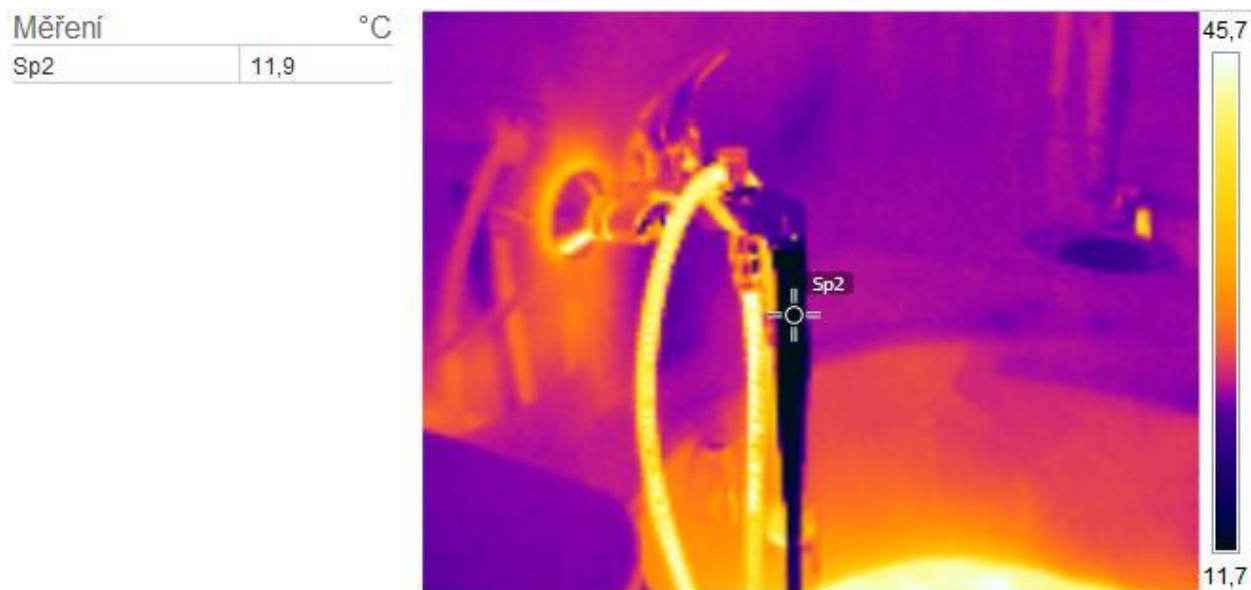
Obrázek 19: Napouštění vany studenou vodou o teplotě 11,9°C (bod Sp2)
