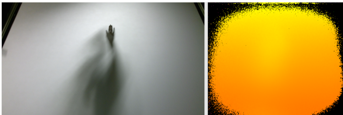
Obrázok 7: Snímky scény pri umiestnení senzora Kinect za polopriehľadnou stenou. Vľavo: RGB kamera. Vpravo: Hĺbkový obraz.
