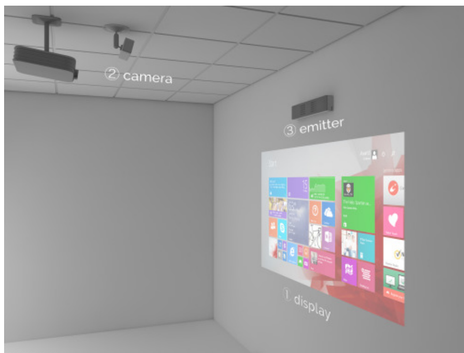
Obrázok 2: Štandardné zapojenie systému od spoločnosti Ubi . V tomto prípade je laserový žiarič umiestnený nad obrazovou plochou.
