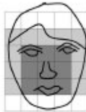
Obrázek 3.2: Typický obličej používaný ve strukturálních metodách. Kódující pravidla jsou založena na znalosti vlastností obličejových oblastí (rozložení intenzity a jejich rozdíl). Převzato z [32].
