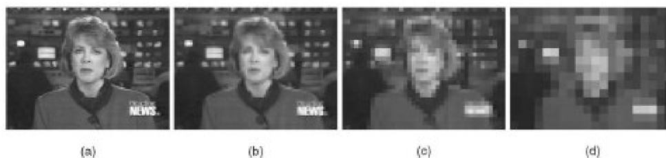
Obrázek 3.1: a) n=1 , původní obrázek, b) n=4 , c) n=8 , d) n=16 . Původní a odpovídající obrázky v nízkém rozlišení. Každá čtvercová oblast se skládá z n \times n bodů u kterých je hodnota intenzity každého bodu nahrazena průměrnou hodnotou intenzity bodů čtvercové oblasti. Převzato z [32].
