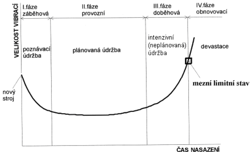
Obr. 4) Časový průběh vibrací – vanová křivka [7]
