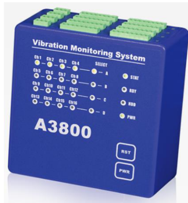
Obr. 9) Kompaktní on-line monitorovací systém A3800 [22]
