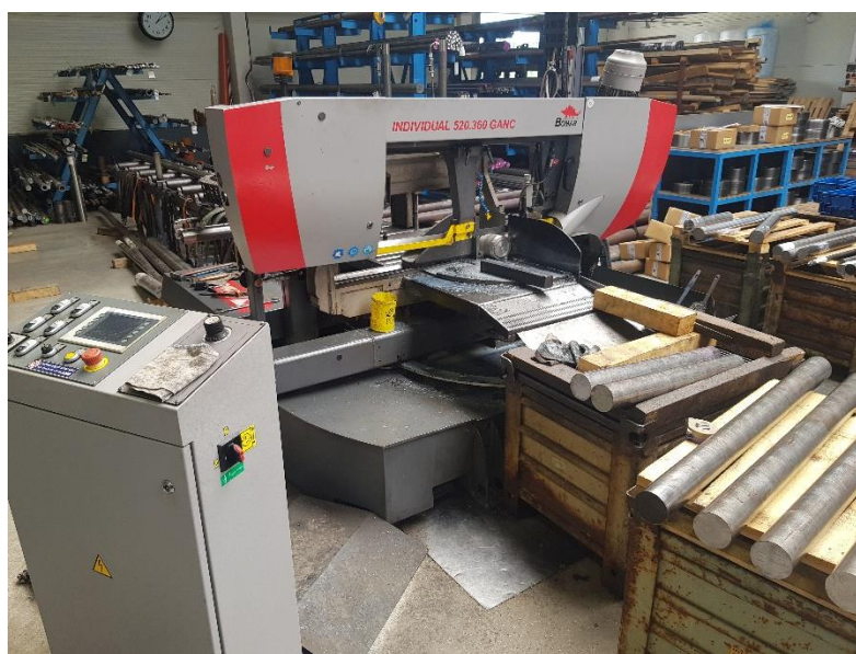
Obr. 13 Automatická pila BOMAR INDIVIDUAL 520.360 GANC.
