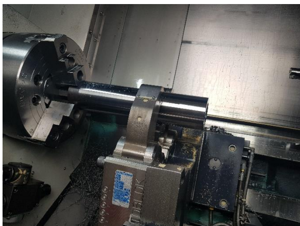
Obr. 17 Soustružení první operace.
