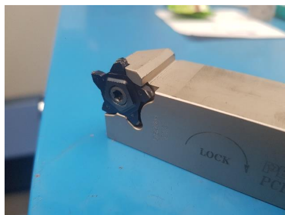
Obr. 24 Nůž vyrobený na zakázku na šroubovici.
