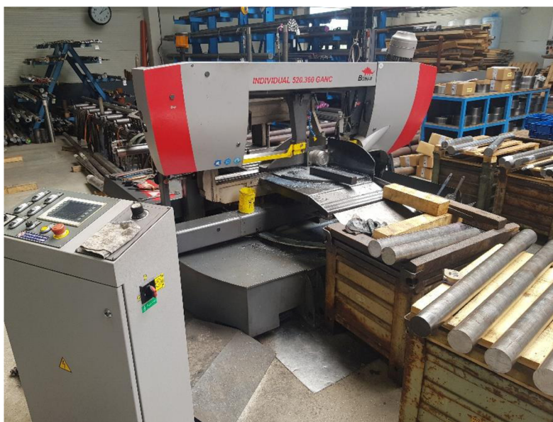
Obr. 13 Automatická pila BOMAR INDIVIDUAL 520.360 GANC.
