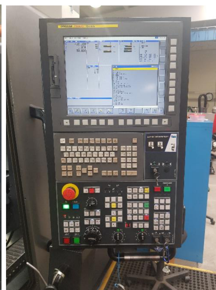
Obr. 16 Ovládací panel soustruhu.
