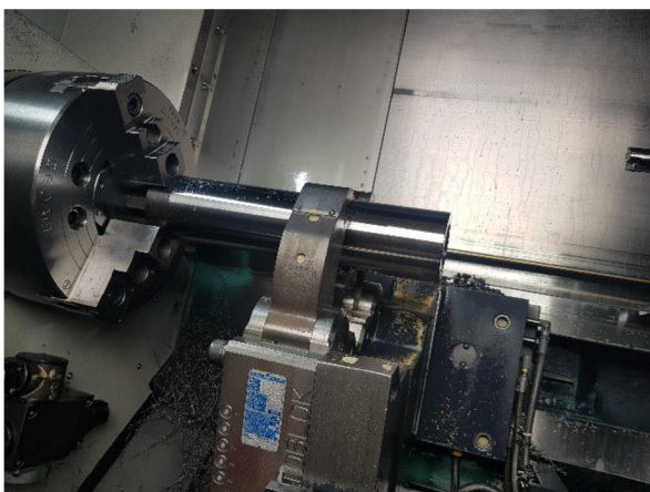
Obr. 17 Soustružení první operace.
