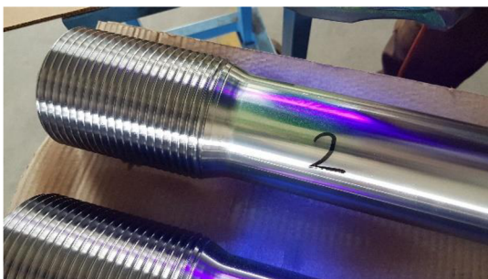
Obr. 27 Kontrola pomocí UV lampy.
