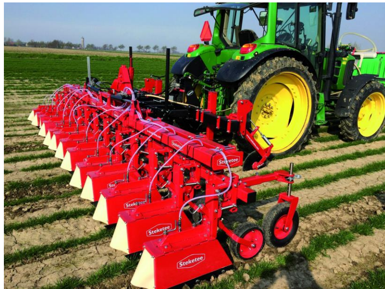
Obrázek 11: Stroj pro aplikaci herbicidu do mezířadí
