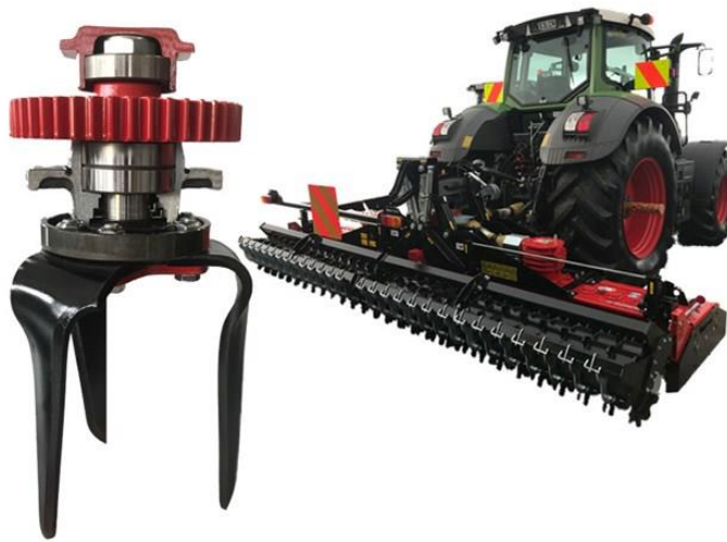
Obrázek 9: Vířivý kypřič, rotor se 3 noži
