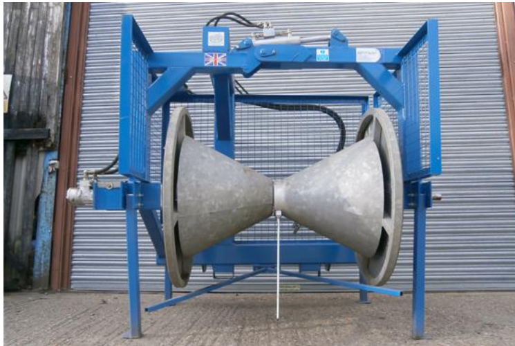
Obrázek 15: Naviják na trubičky kapkové závlahy
