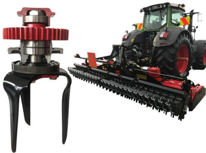
Obrázek 9: Vířivý kypřič, rotor se 3 noži
