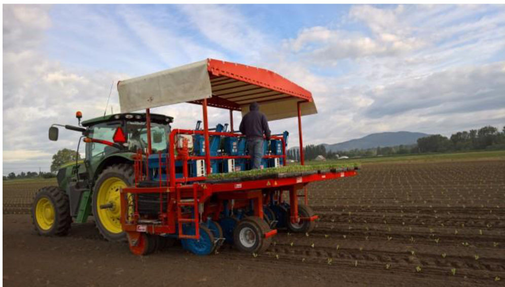
Obrázek 10: Sázeční stroj s automatickým vkládáním sazenic do sázečních kotoučů
