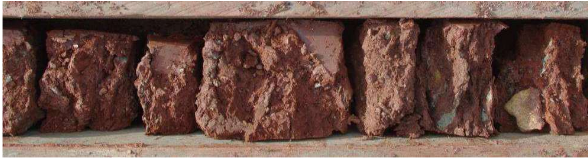
Obrázok 4.26: Materiál pôvodného násypu z rokov 1871 – 1872 [24].
