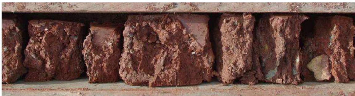
Obrázok 4.26: Materiál pôvodného násypu z rokov 1871 – 1872 [24].
