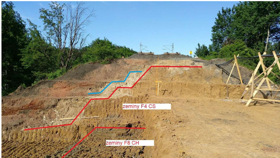
Obrázok 4.5: Priečný rez telesom pôvodného násypu a prísypu [9].
