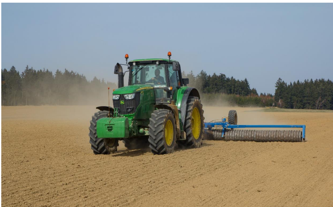
Obrázek 1.7: Válení po zasetí s cambridge válci Dalbo Minimax
