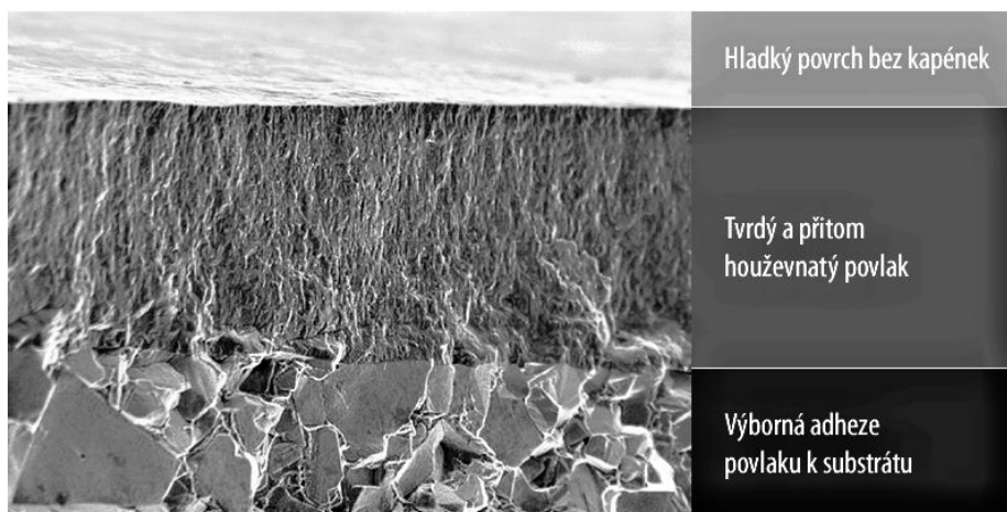
Obr. 11 Průřez povlakem (pvd.cz)
