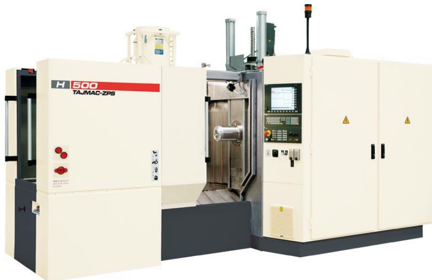
Obr. 17 Horizontální obráběcí centrum (tajmac-zps.cz)
