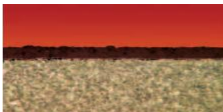
Obr. 14 Multivrstvý PVD povlak (pramet.cz)
