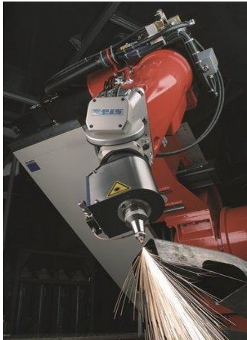
Obr. 26 Laser při řezném procesu (mmspektrum.com)
