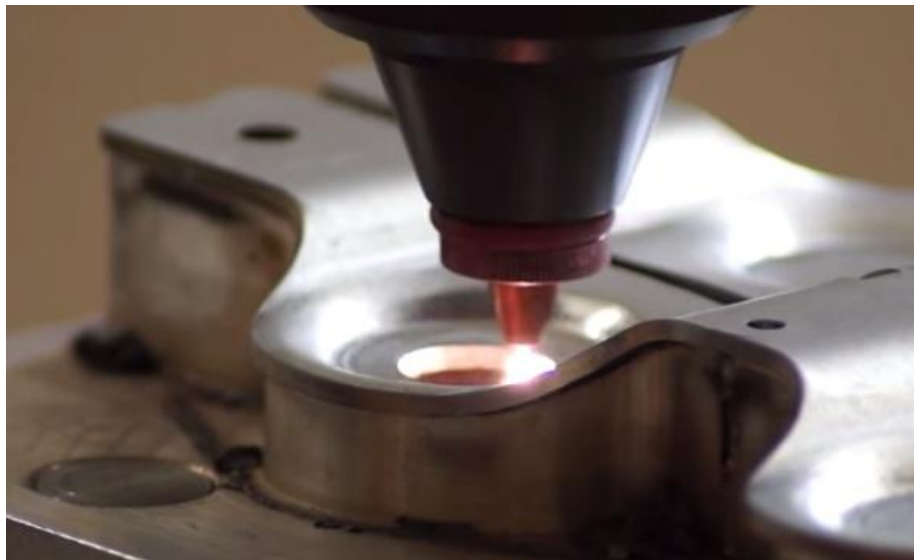
Obr. 31 Detail řezu vláknového laseru (lao.cz)
