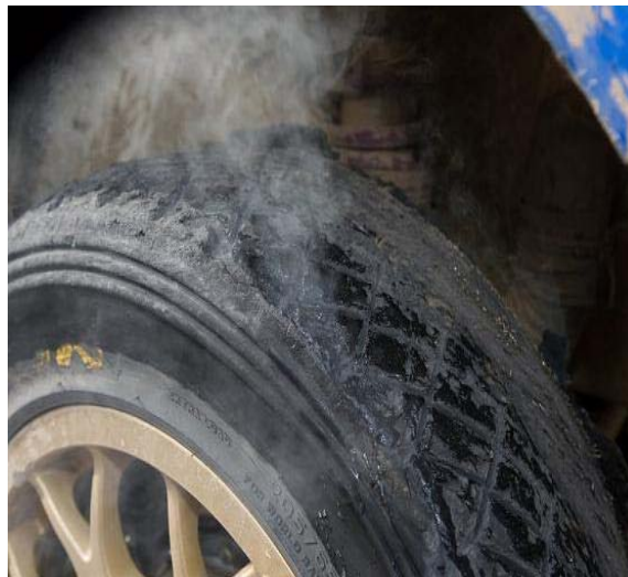
Obr. 29 Pneumatiky po absolvování velmi náročného povrchu na Rally Akropolis [51]
