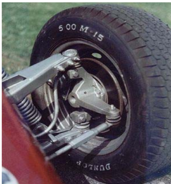
Obr. 11 McPherson dvojitě zavěšení kola s trojúhelníkovým ramenem[32]
