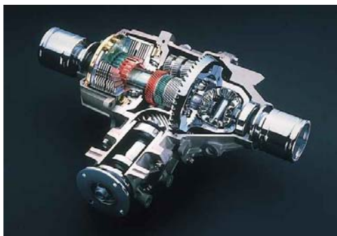
Obr. 25 zadní elektro-hydraulicky řízený diferenciál [46]
