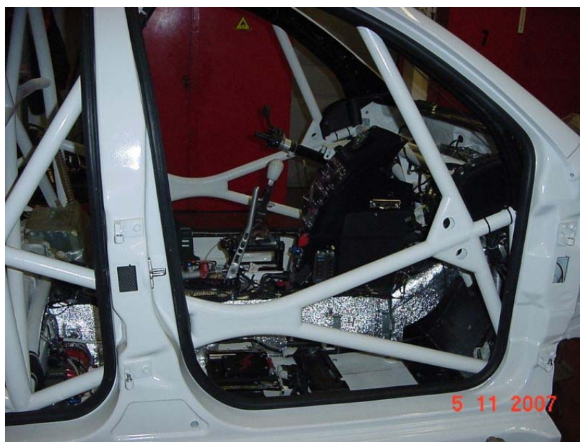
Obr. 9 Sváry rámu ve tvaru X chránící posádku před bočním nárazem [30]
