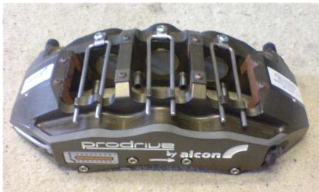
Obr. 27 Šesti-pístkový třmen od firmy Prodrive [49]
