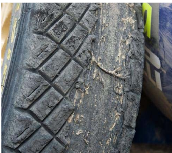
Obr. 29 Pneumatiky po absolvování velmi náročného povrchu na Rally Akropolis [51]
