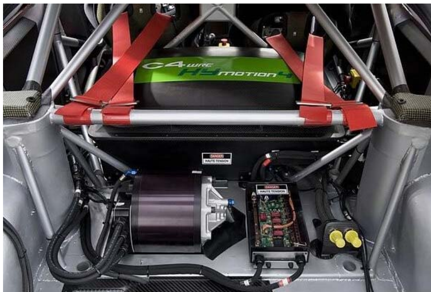
Obr. 65 Rekuperační jednotka s řídicí jednotkou a skříň s lithiovými články [87]
