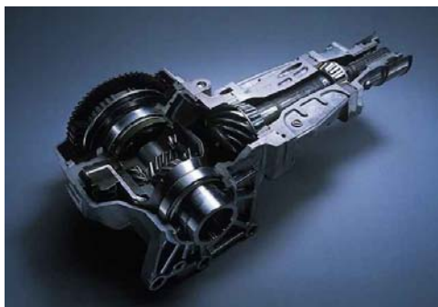
Obr. 24 mezinápravový aktivní diferenciál Mitsubishi [45]
