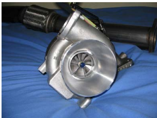
Obr.17 Turbodmychadlo vozu Mitsubishi Lancer WRC 05 [38]
