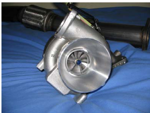
Obr.17 Turbodmychadlo vozu Mitsubishi Lancer WRC 05 [38]
