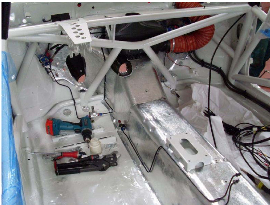
Obr. 7 Část rámu chránící posádku při čelním nárazu před vniknutím motoru do kokpitu [28]
