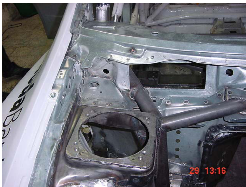
Obr. 8 Svár mezi rámem a upevněním tlumičů [29]
