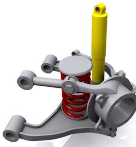
Obr. 16 Více-prvkový systém zavěšení Multi-link [37]
