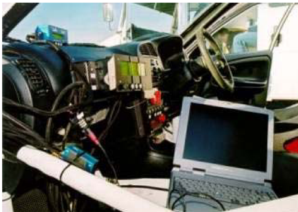
Obr. 63 Testování s Gems DA50 data logger [85]
