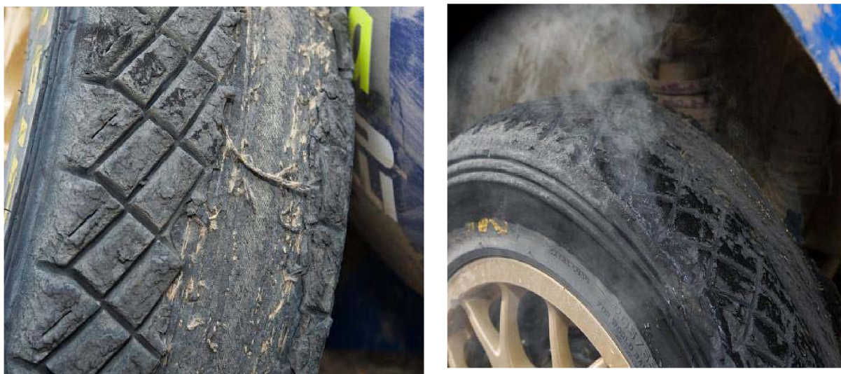
Obr. 29 Pneumatiky po absolvování velmi náročného povrchu na Rally Akropolis [51]
