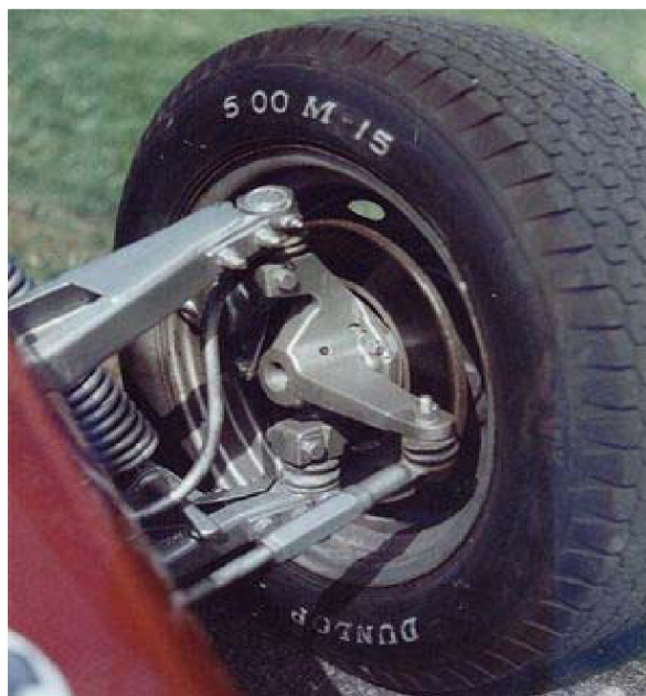
Obr. 11 McPherson dvojitě zavěšení kola s trojúhelníkovým ramenem[32]
