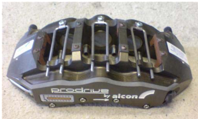
Obr. 27 Šesti-pístkový třmen od firmy Prodrive [49]
