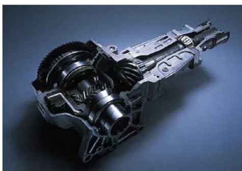
Obr. 24 mezinápravový aktivní diferenciál Mitsubishi [45]
