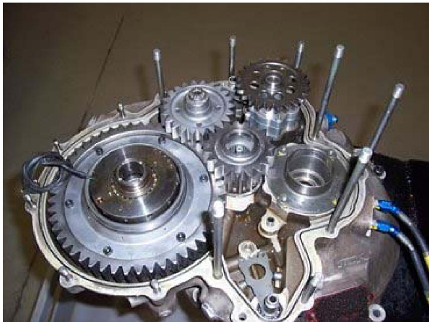
Obr. 22 Převodovka vozu Subaru Impreza WRC 05 [43]
