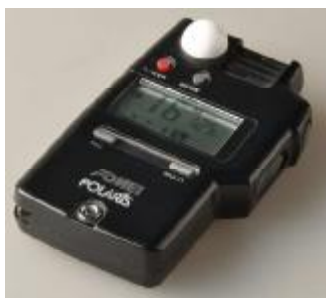
Obrázek 9 - expozimetr používaný pro měření zábleskových světel na scéně. Hodnota 125 ukazuje nastavenou rychlost závěrky 1/125. Větší číslice udává hodnotu clony na základě změřené expozice.
