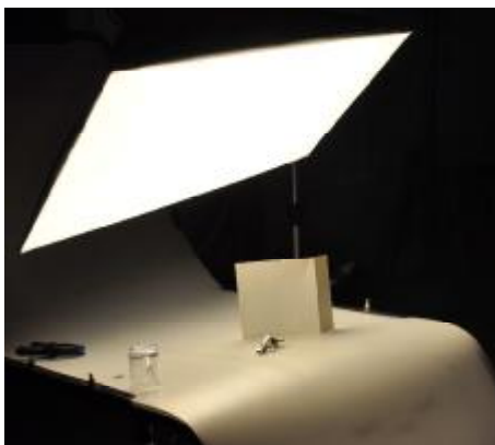
Obrázek 13 - pro fotografii plochého kovového předmětu postačil pro rozptýlení světla bílý papír
