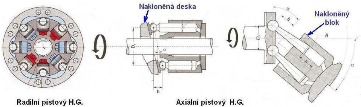
Obr. 1.2 Schéma radiálních a axiálních pístových čerpadel [1]
