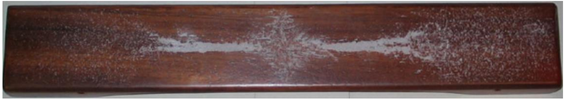
Obr. 16: Chladniho obrazce: Třetí torzní mód [12]
