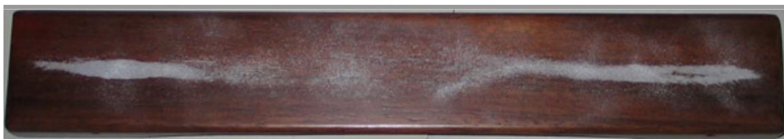
Obr. 9: Chladniho obrazce: První torzní mód [12]
