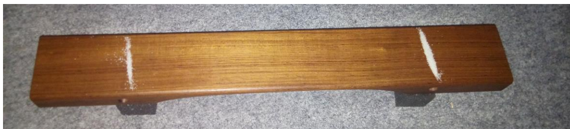
Obr. 49: První ohybový mód vybuzený paličkou, palisandr Dis3
