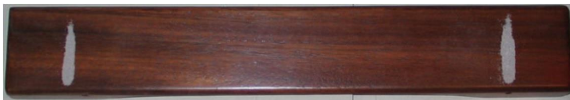
Obr. 8: Chladniho obrazce: První ohybový mód [12]
