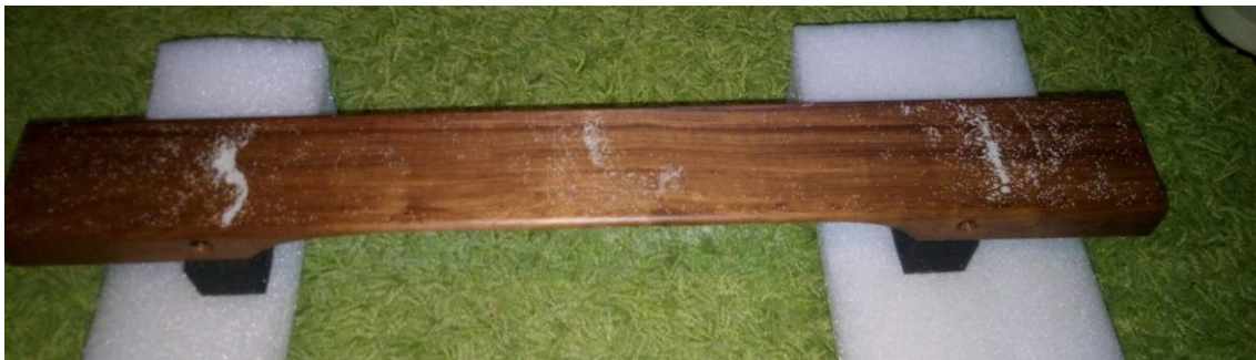
Obr. 52: Druhý ohybový mód vybuzený reproduktorem
