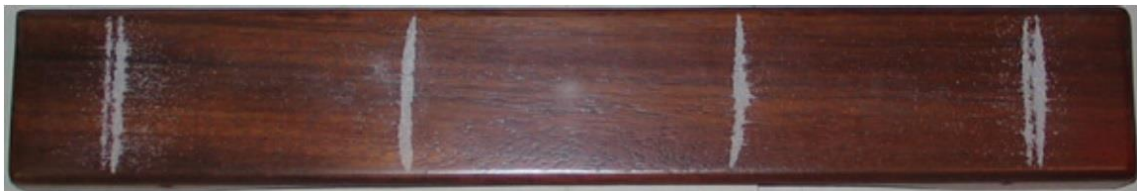
Obr. 14: Chladniho obrazce: Třetí ohybový mód [12]
