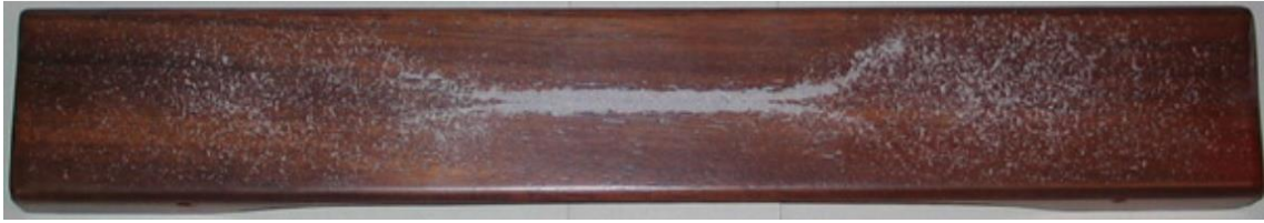
Obr. 12: Chladniho obrazce: Druhý torzní mód [12]
