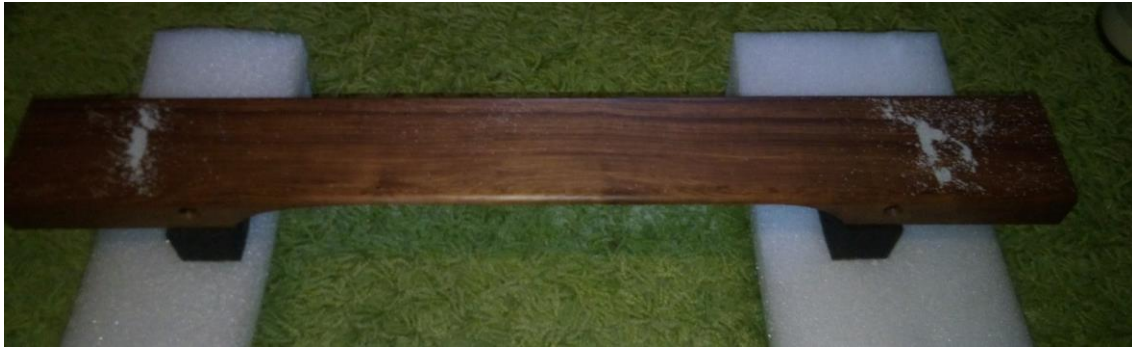
Obr. 51: První ohybový mód vybuzený reproduktorem
