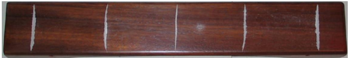
Obr. 18: Chladniho obrazce: Čtvrtý ohybový mód [12]
