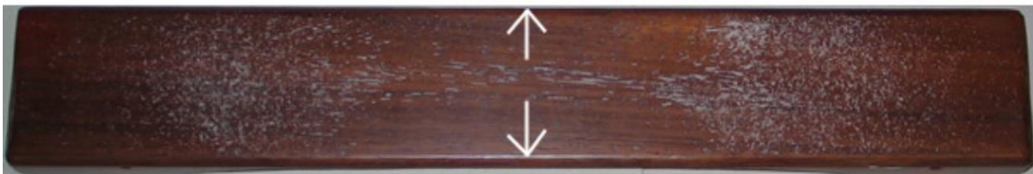
Obr. 15: Chladniho obrazce: První podélný mód [12]
