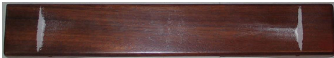
Obr. 11: Chladniho obrazce: Druhý ohybový mód [12]
