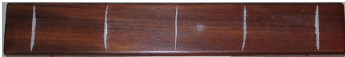
Obr. 18: Chladniho obrazce: Čtvrtý ohybový mód [12]
