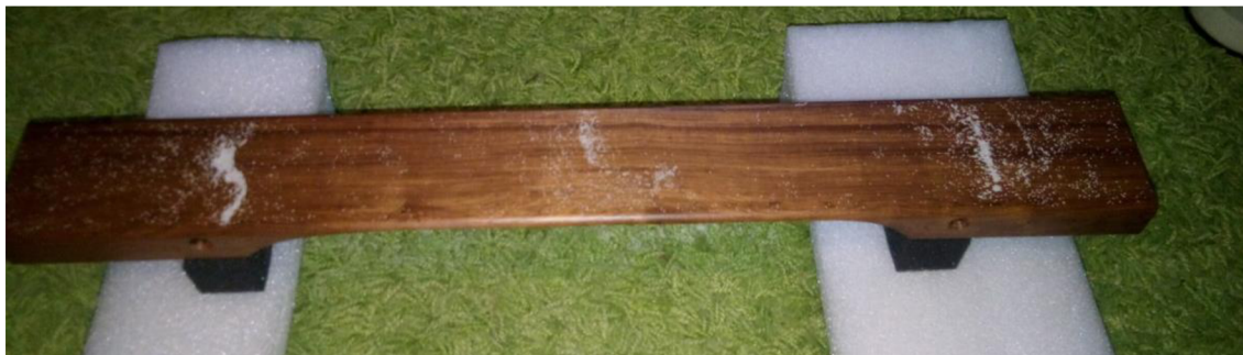
Obr. 52: Druhý ohybový mód vybuzený reproduktorem
