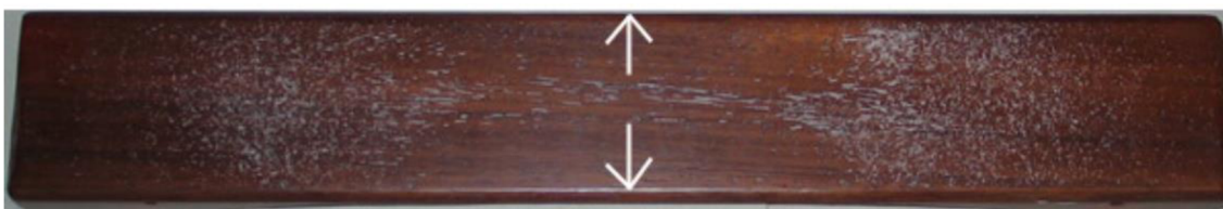
Obr. 15: Chladniho obrazce: První podélný mód [12]
