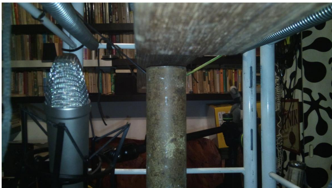
Obr. 62: Příklad snímání v blízkosti kamene a ocelového rezonátoru
