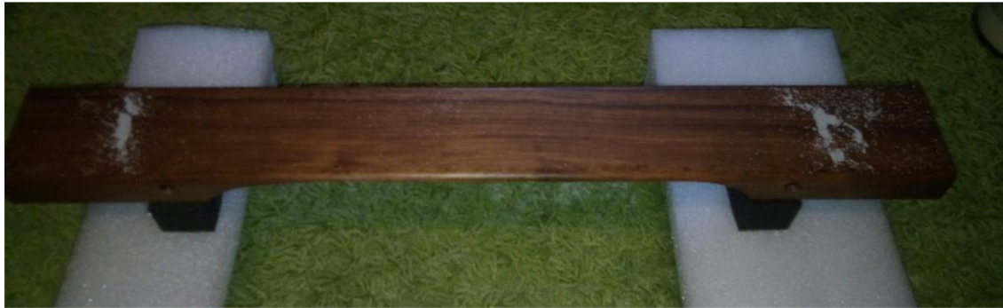
Obr. 51: První ohybový mód vybuzený reproduktorem
