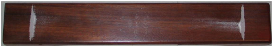
Obr. 11: Chladniho obrazce: Druhý ohybový mód [12]
