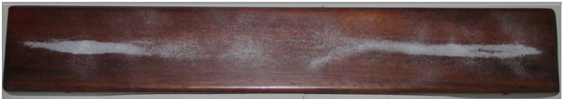
Obr. 9: Chladniho obrazce: První torzní mód [12]
