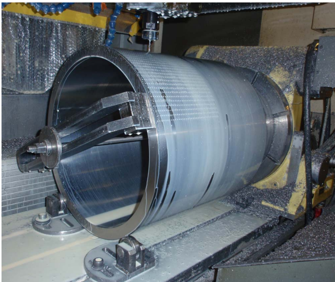
Obr. 4.1 Předvrtávání děr o \varnothing 3 mm
