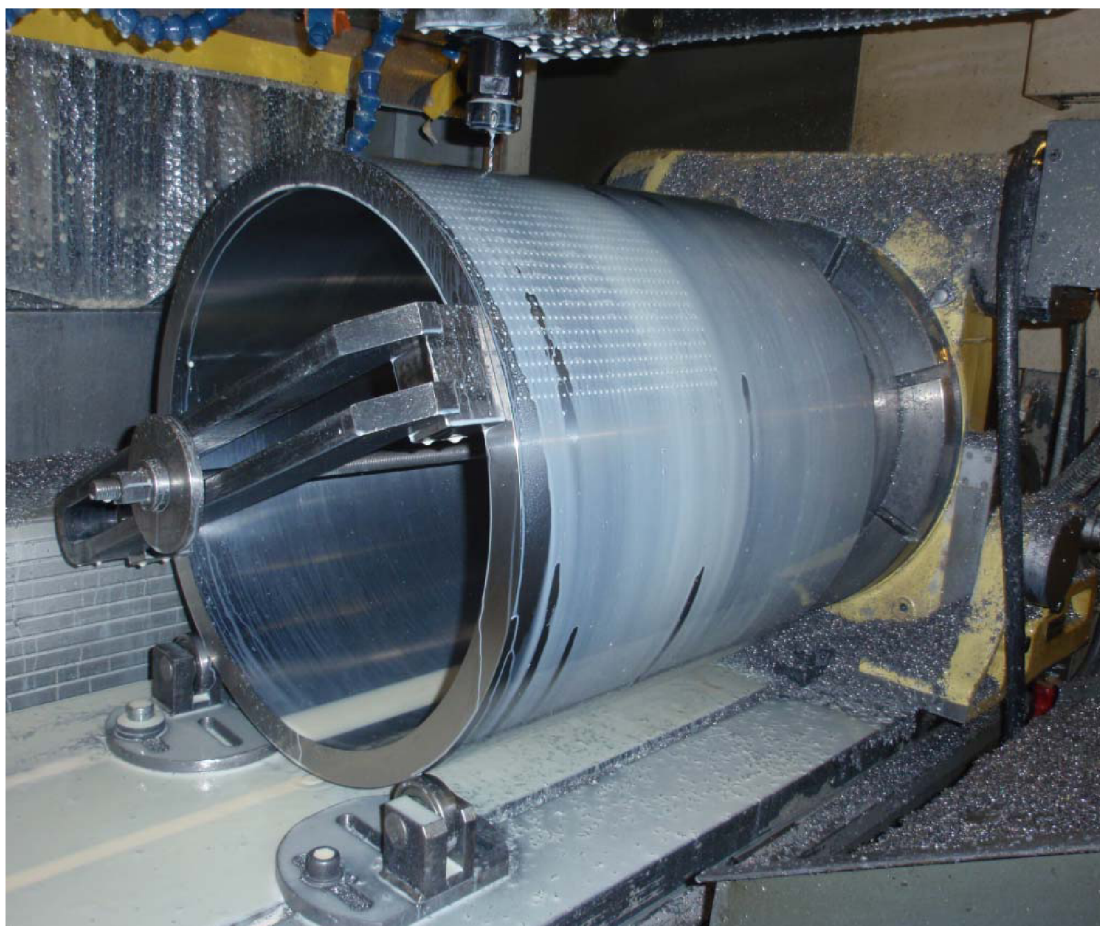
Obr. 4.1 Předvrtávání děr o \varnothing 3 mm
