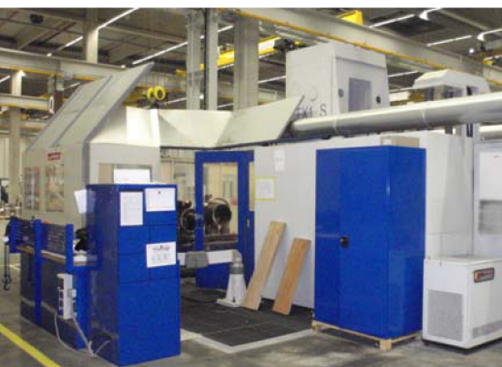
Obr. 1.8 Pětiosé frézovací centrum Juaristi TX1S
