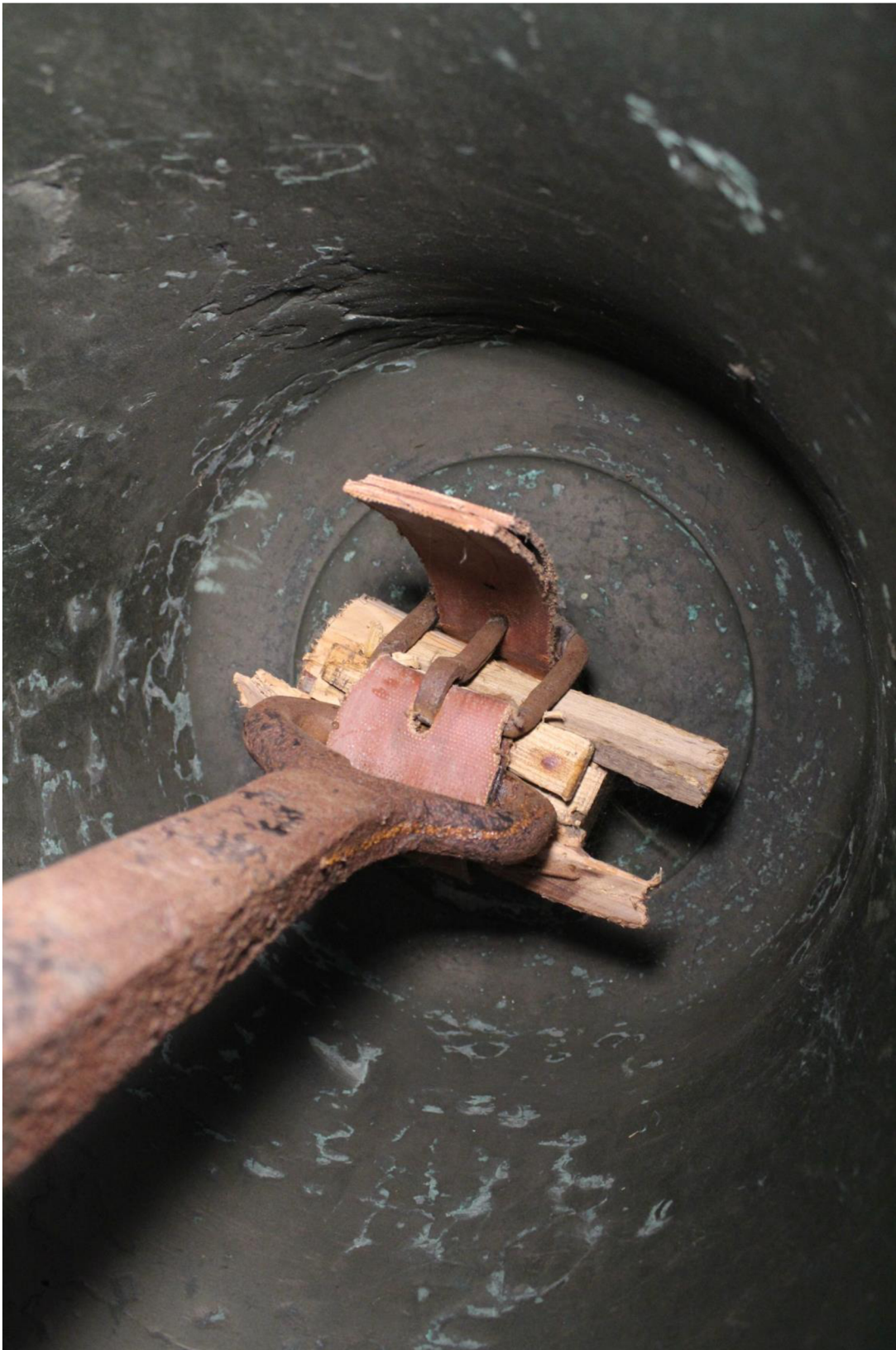
Obr.4. Zvon v Bílém Újezdu – poškození drátěnkou, znečištění ptačím trusem.
