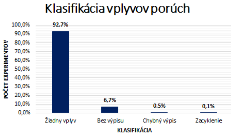
Obr. A.3: Graf výsledkov experimentov s aplikáciou na riadenie úloh pomocou fronty.
