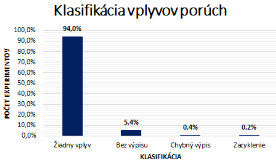
Obr. A.8: Graf výsledkov experimentov s aplikáciou na radenie pomocou úloh.
