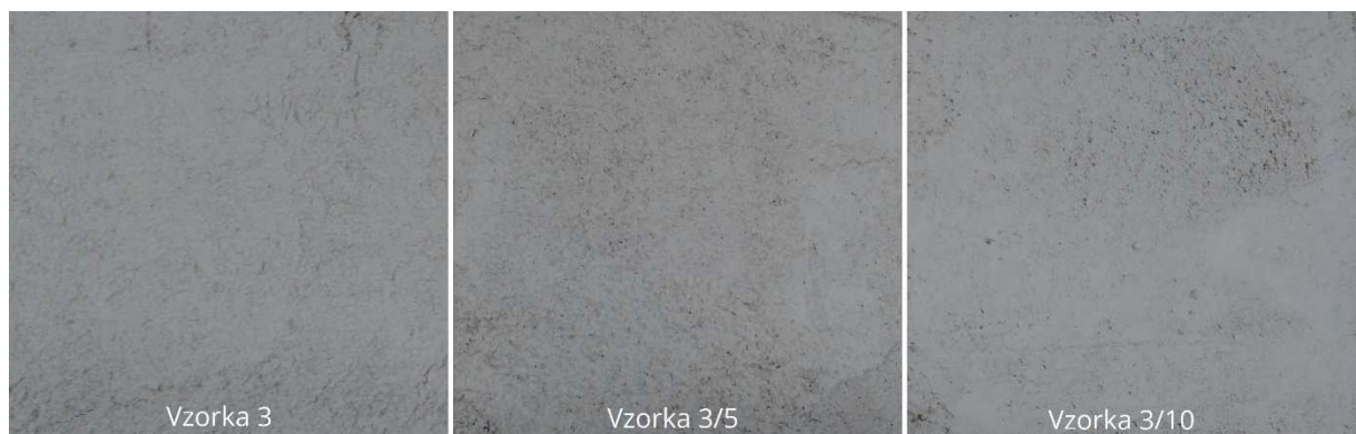
Obr. 13: Zatvrdnutý povrch mált pri skúške aplikačných vlastností
