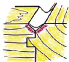
Obrázek č. 12 Správně ošetřená V-spára (převzato z [21])
