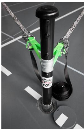
Obrázok 14. Kotvenie o podlahové volejbalové objímky, Fotka: www.mobile.ch
