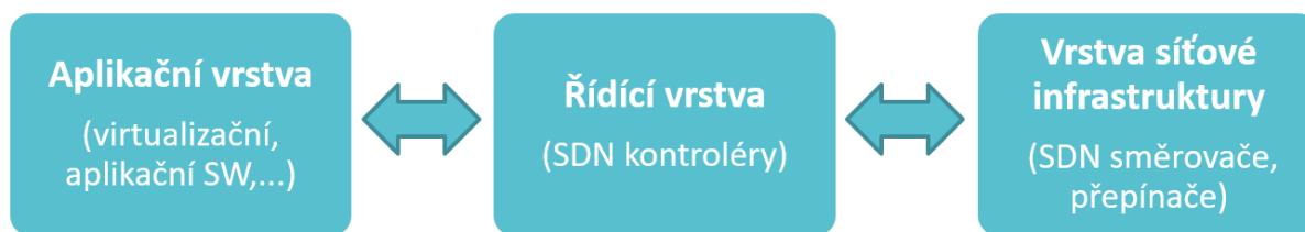
Obr. 2.1: Diagram funkčních prvků softwarově definovaných sítí SDN
