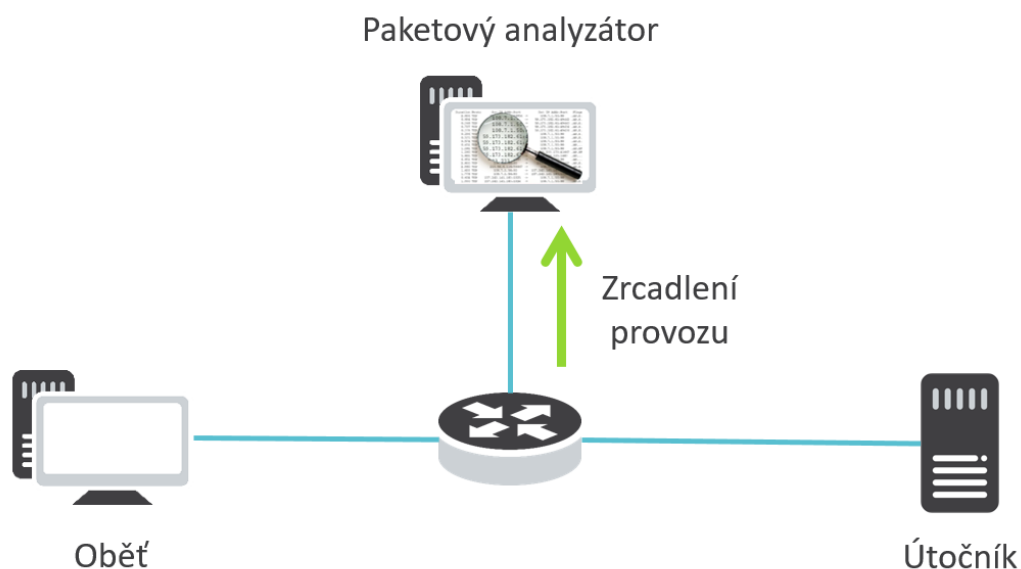
Obr. 1.3: Koncept síťového monitoringu analýzou celého provozu (paketů)
