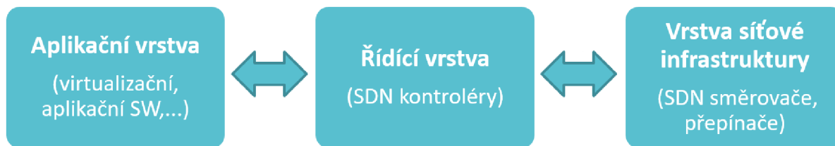
Obr. 2.1: Diagram funkčních prvků softwarově definovaných sítí SDN
