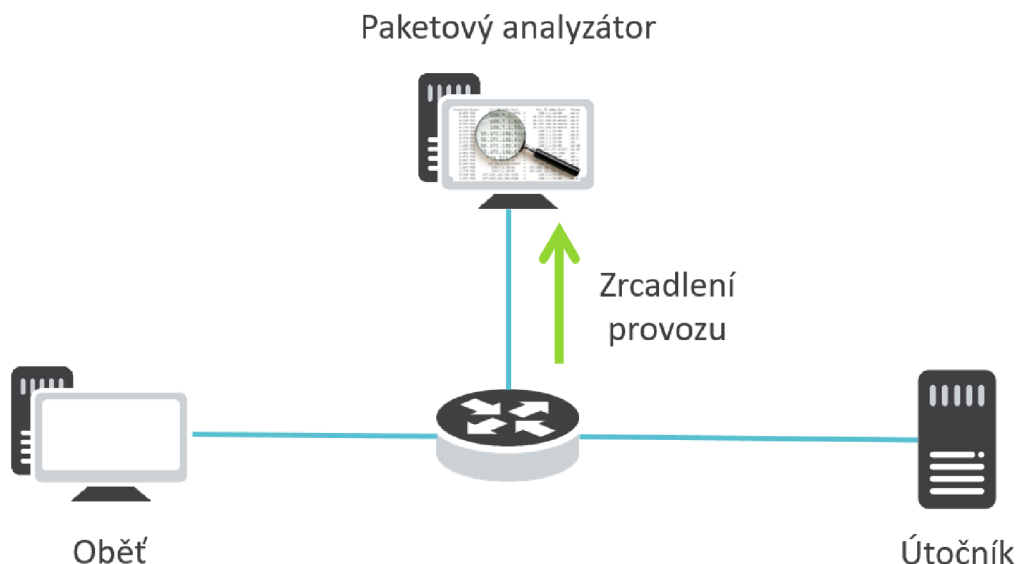
Obr. 1.3: Koncept síťového monitoringu analýzou celého provozu (paketů)
