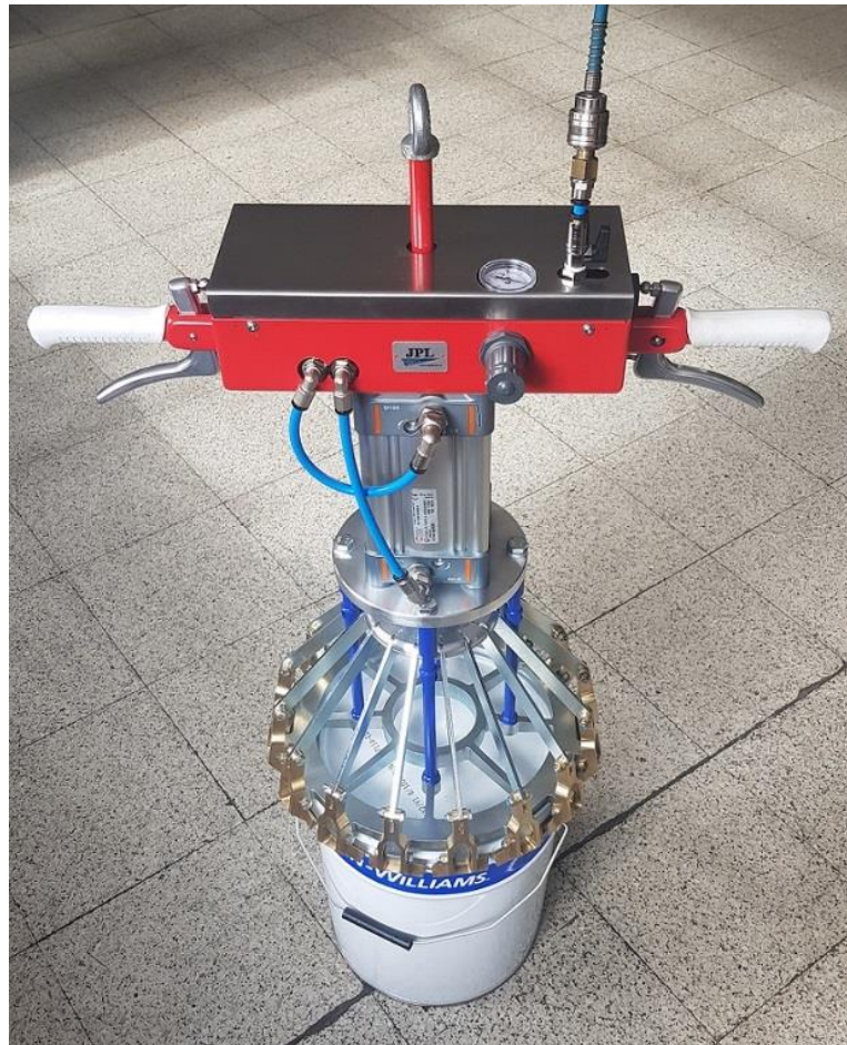
PŘÍLOHA Č. 3: Strojní zařízení na zavírání plechovek (Zdroj: ©jplkovo.cz, 2020)
